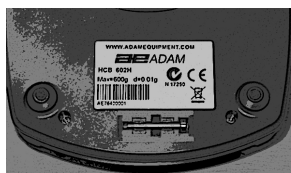
Место хранения ручки для опускания встроенной юстировочной гири
